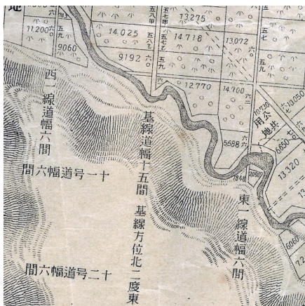
図2 アッカベツ殖民区画图(M33)/ 基線に「基線方位北二度東」とあり
