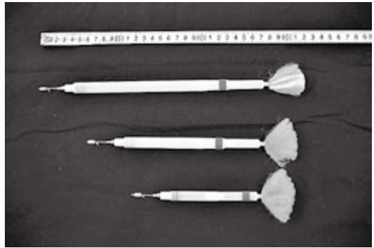
図10. DAN-INJECT社製の投薬器. 上から5 mL, 3 mL, 1.5 mLの各タイプ. バイオプシダートには1.5 mLを用いる.
