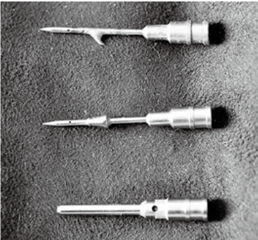
図9. DAN-INJECT社製の麻酔銃用針. 上から麻酔薬注入用の針状の返し付きのタイプ (barbed) と円錐形のスカート状の返し付きのタイプ (collared). 一番下がバイオプシダート針.
