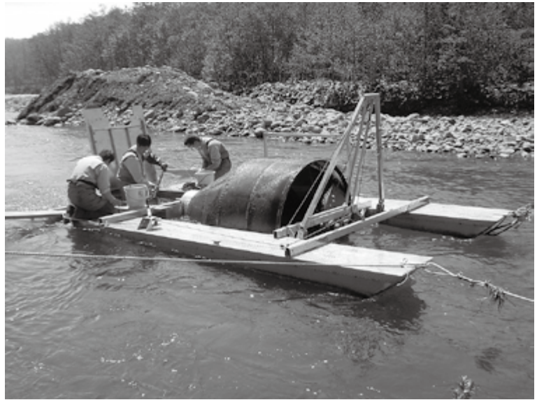
図2. ロータリー式スクリュートラップ. Fig. 2. Rotary screw trap.
