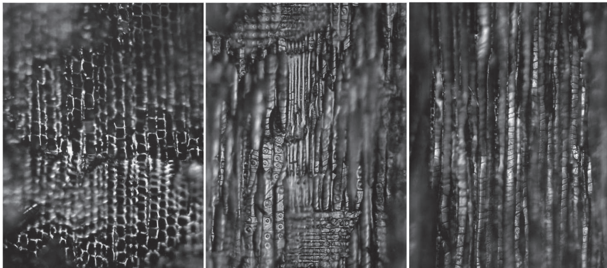
横断面 0.1mm 放射断面 0.1mm 接線断面 0.1mm イチイ TR5 No.645 床
